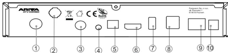
1. Entrada de antena de televisión terrestre en COMBO o satélite en el modelo TT
