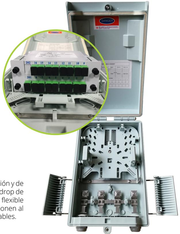
La nueva caja de KMC-Fast 2 de Ofp se utiliza como punto de terminación y de paso del cable de alimentación principal para conectar con los cables drop de abonados en las redes de comunicación FTTx. Permite un despliegue flexible y racional ya que se puede conectar los clientes a medida que se abonen al servicio gracias a los modulos splitters de 4 a 16 puertos intercambiables. Permite dar servicio a 16 abonados.
