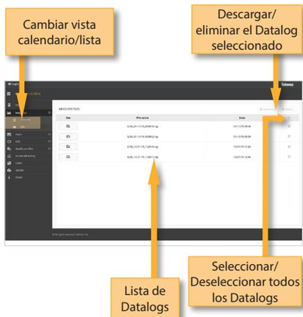
Utilizando los botones situados en la parte superior derecha de la pantalla, podrá eliminar el Datalog seleccionado o descargarlo a su ordenador en formato .xls (se generará un fichero .xls para cada Datalog y se descargarán todos juntos en un fichero .zip)
