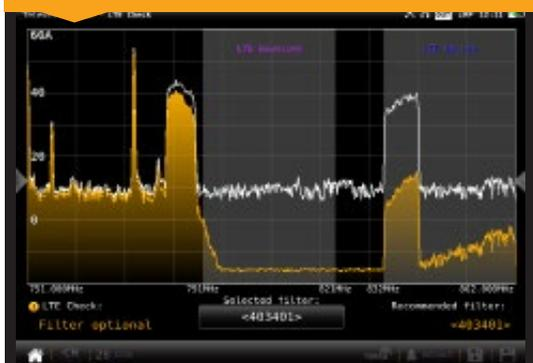
Analiza la influencia de la señal LTE sobre canales TDT, detectando la necesidad de incorporar o no filtros. Además permite simular el espectro tras haber incorporado un filtro LTE que el propio medidor recomienda. Se presenta un listado de filtros para que el usuario pueda elegir el que más se ajuste a su instalación.
