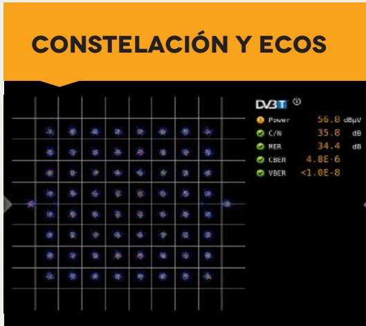
Sin duda dos herramientas fundamentales para asegurar una correcta recepción de la señal. El diagrama de constelación es indispensable para ayudar a detectar la presencia de ruido, jitter de fase, interferencias y otros problemas que pueden afectar a la calidad de la señal reduciendo la MER. La representación gráfica de los ecos permite identificar la presencia de los mismos en la recepción de la señal terrestre DVB-T/T2, lo que hace que se pueda degradar considerablemente la medida de BER.
