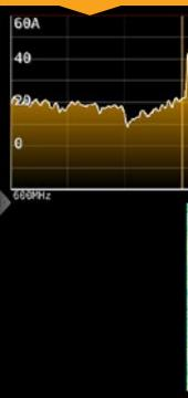
Representación gráfica de la frecuencia. Los niveles de potencia son representados en una escala de decibelios. Esta herramienta óptima permite la captura de desvanecimientos de señal que no son detectables solamente con espectro de potencia.
