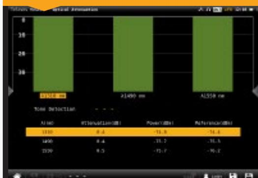
Una vez activada la entrada de fibra óptica y gracias al receptor óptico (selectivo o no) es posible medir atenuaciones ópticas en tres longitudes de onda (1310nm, 1490nm y 1550nm) y sus potencias, además de permitir analizar instalaciones RFoG.
