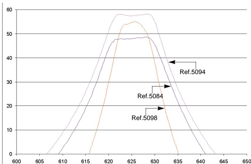
La gran novedad de esta nueva gama de amplificación es el módulo selectivo **ref.5098**. Este módulo permite la instalación de canales adyacentes y el ajuste independiente en grupos de canales digitales.
