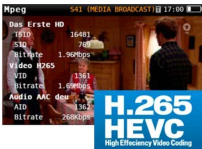
Esta funcionalidad soporta el nuevo formato de compresión HEVC H.265 y permite visualizar señales de vídeo con una resolución máxima Full HD (1920 x 1080). La visualización puede ser en la pantalla medidor, y también en la del dispositivo móvil (modo multipantalla) si su hardware es compatible H.265 (normalmente un smartphone, tablet o PC).
