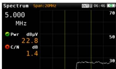
La capacidad del medidor para medir el canal de retorno a partir de 5 MHz, resulta una herramienta muy útil para los instaladores de cable. Mediante la visualización de la señal en el espectro, medida de potencia y C/N, es posible garantizar el buen estado y calidad de los datos de subida transmitidos en este ancho de banda.
