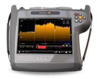
Con un procesado digital ultrarrápido conseguimos tiempos de barrido de <10 ms y un elevado margen dinámico de >50dB. Está dotado de funciones avanzadas para la detección y el análisis de señales entre 5 MHz y 3300 MHz, como por ejemplo la función Waterfall, disparo por eventos, marcas RBW y VBW configurable por el usuario.
