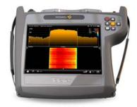
Los niveles de señal se convierten a color y son representados en el eje temporal. Una herramienta óptima para analizar interferencias o desvanecimientos de señal de corta duración difíciles de observar en modo espectro.
