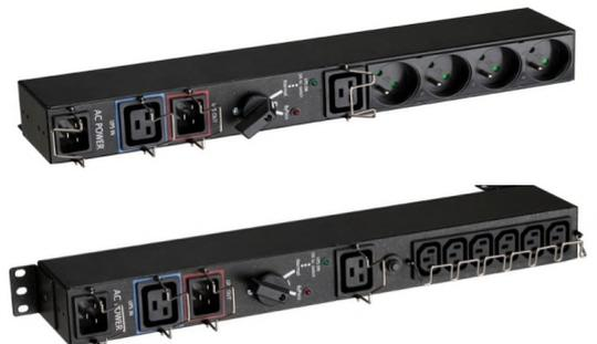
BY-PASS Externo para Mantenimiento de los UPS en caso de necesitar mantenimiento del mismo con el se consigue que las cargas conectadas al SAI sigan en funcionamiento mientras se atiende o se realiza mantenimiento al SAI
